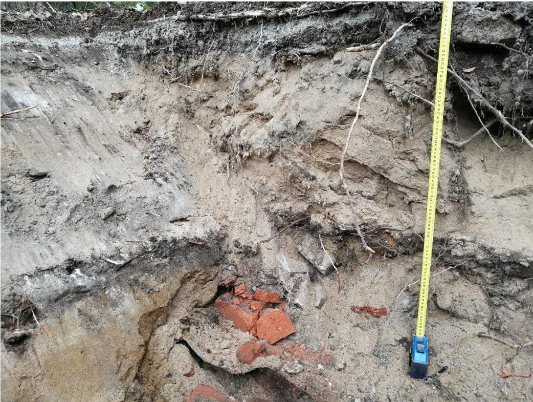
Kuva 3. Tutkimuspiste SW20, lähikuva mustasta kerroksesta. Kerroksen esiintymissyvyys ja paksuus määritettiin mitalla.
