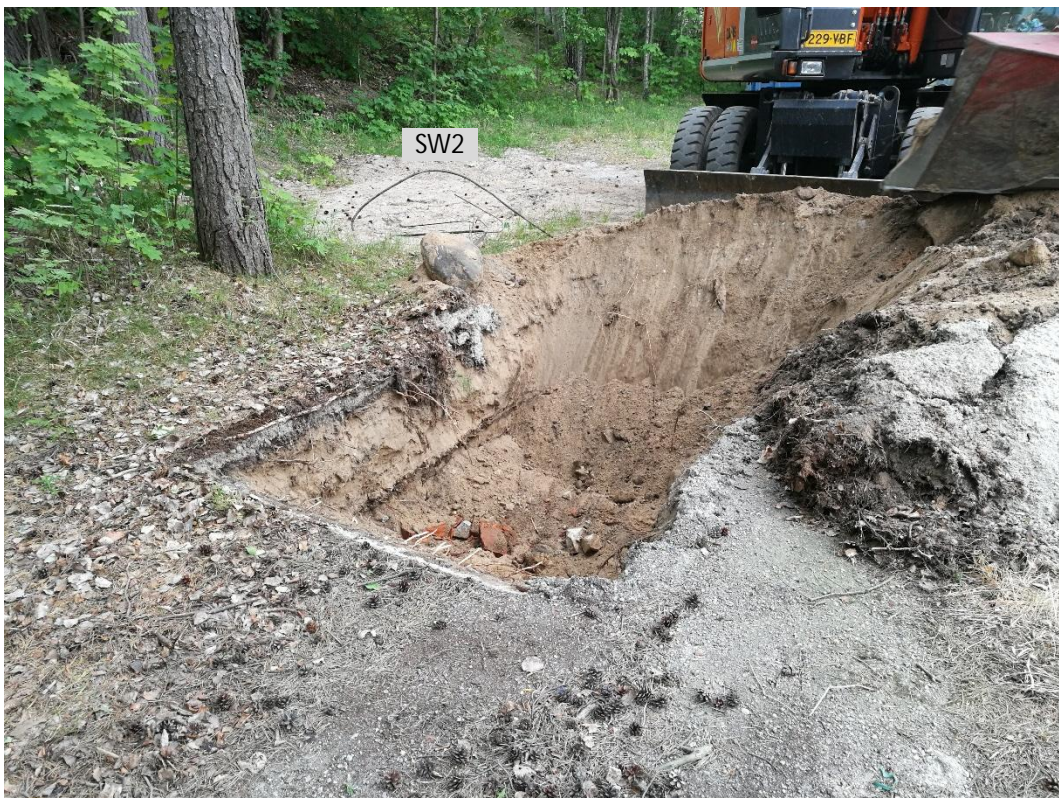
Kuva 2. Tutkimuspiste SW20. Tutkimuspisteessä todettiin hieman rauditusrautoja ja runsaasti tiiltä. Taustalla aiemman tutkimuksen tutkimuspiste SW2.
