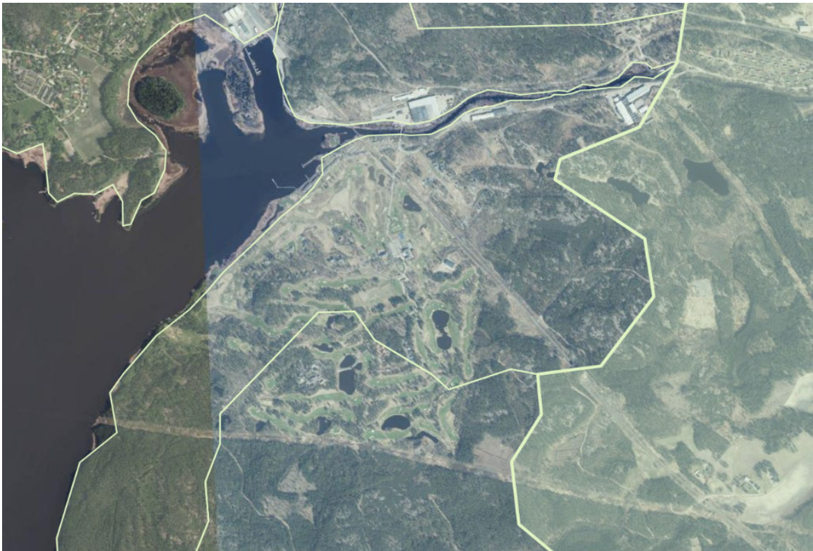
Kuva 12. Keltaiset viivat osoittavat alueen valuma-alueet. Benzin kenttäalue sijoittuu pääosin muusta alueesta erilliseen kaakkoisosan valuma-alueeseen. kartta: https://karta.raseborg.fi/
