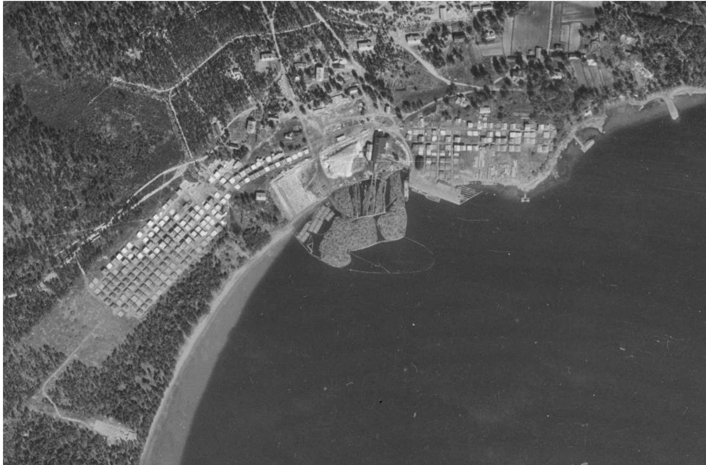
Vuoden 1950 ilmakuvasa saha sijaitsee vielä alkuperäisellä paikallaan kylän tuntumassa. Meressä sahan edustalla näkyy runsaasti eri lohkoihin ryhmitettyjä tukkeja. Rannan läheisyydessä sahan molemmin puolin on laajat tapulipihat, tiukasti suorakulmaiseen koordinaatistoon ryhmitettyine tapuleineen. Sahan eteläpuolella puustoinen vyöhyke erottaa tapulipihan vielä luonnontilaiselta näyttävästä rannasta. Sahan tulevaa paikkaa kuvan alareunassa on ryhdytty raivaamaan. Kuva Maanmittauslaitos paikkatietoikkuna.
