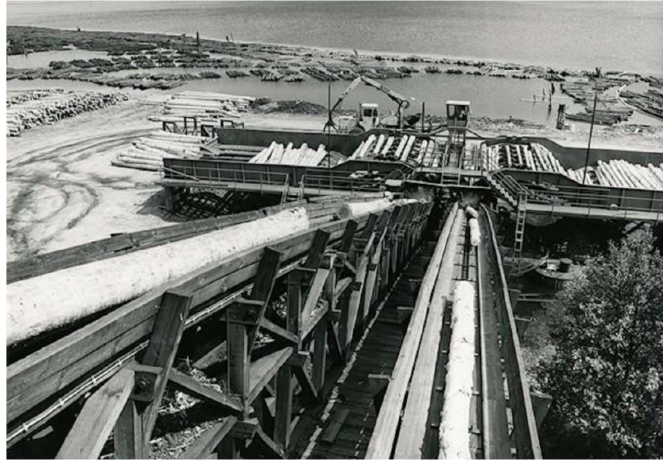
Metsä-Skogbyn sahan vuonna 1979 käyttöön otetut uudet syöttöpöydät. Edessä oleva pesuri puhdistaa hiekan tukeista. Kuva Lusto-Suomen metsämuseo. Laine, Kauno, Valokuvaaja 1982. Finna
