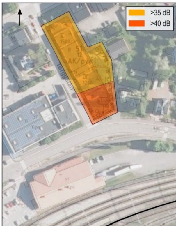
Bild 22. Riktvärdet för stombuller, 35 dB, kan enligt beräkningarna överskridas om man i byggnaderna använder golvvärme vilket man behöver beakta i byggnadernas konstruktioner med ändamålsenliga bekämpningsmetoder.
