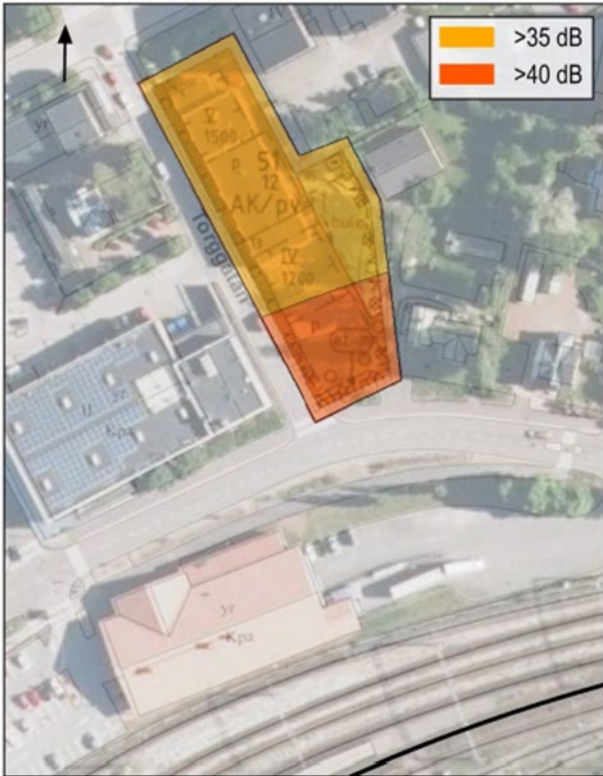
Kuva 22. Laskelmien mukaan rakennemelun ohjearvo 35 dB voi ylittyä, jos rakennuksissa käytetään lattialämmitystä. Tämä tulee huomioida rakennusten rakenteissa asianmukaisin ohjausmenetelmin.
