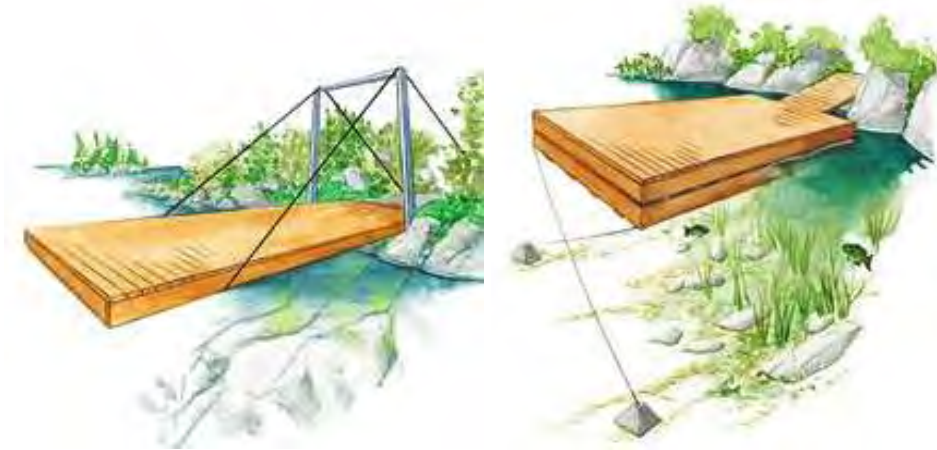
Kuva 13. Esimerkki riippulaiturista ja ponttonilaiturista.
