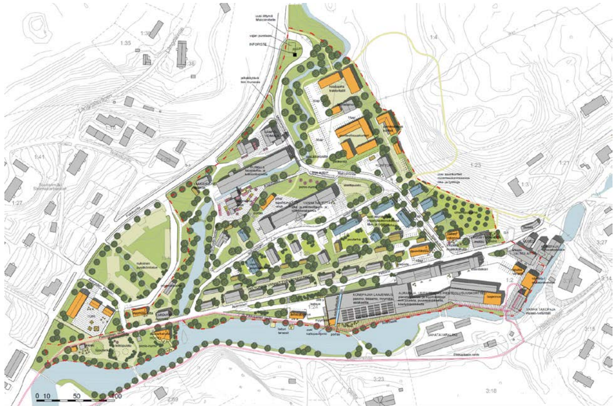
Illustration för referensplanen (Arkitektbyrå Kristina Karlsson). Nya byggnader som huvudsakligen är avsedda för bostäder har markerats med blått och byggnader som innehåller arbetsutrymmen, småindustri och service med orange. Förråds- och hjälputrymmen har markerats med brunt och befintliga byggnader med grått.
